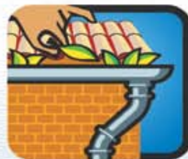
Remova folhas, galhos e tudo que possa impedir a água de correr pelas calhas.
